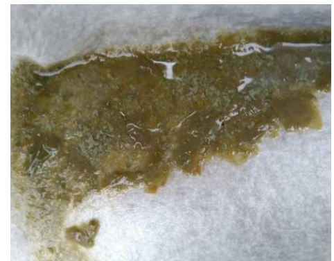
Abbildung 4: Biofilmaustrag während der Comprex®-Reinigung
