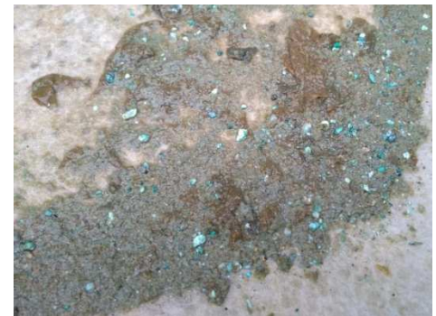
Abbildung 3: Partikelaustrag während der Comprex®-Reinigung
