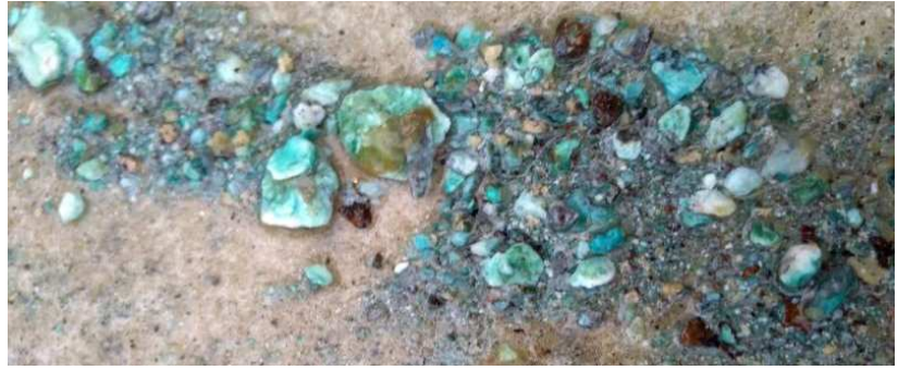
Abbildung 1: Partikelaustrag während der Comprex®-Reinigung
