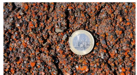
Abbildung 5: ausgetragene Verunreinigungen aus Rohrbündelwärmetauscher
