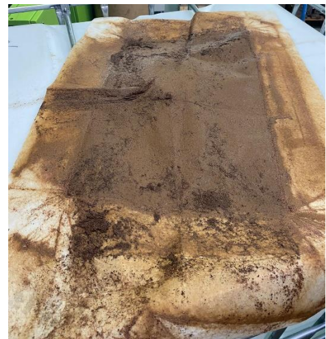
Abbildung 4: ausgetragene Ablagerungen auf Filtervlies
