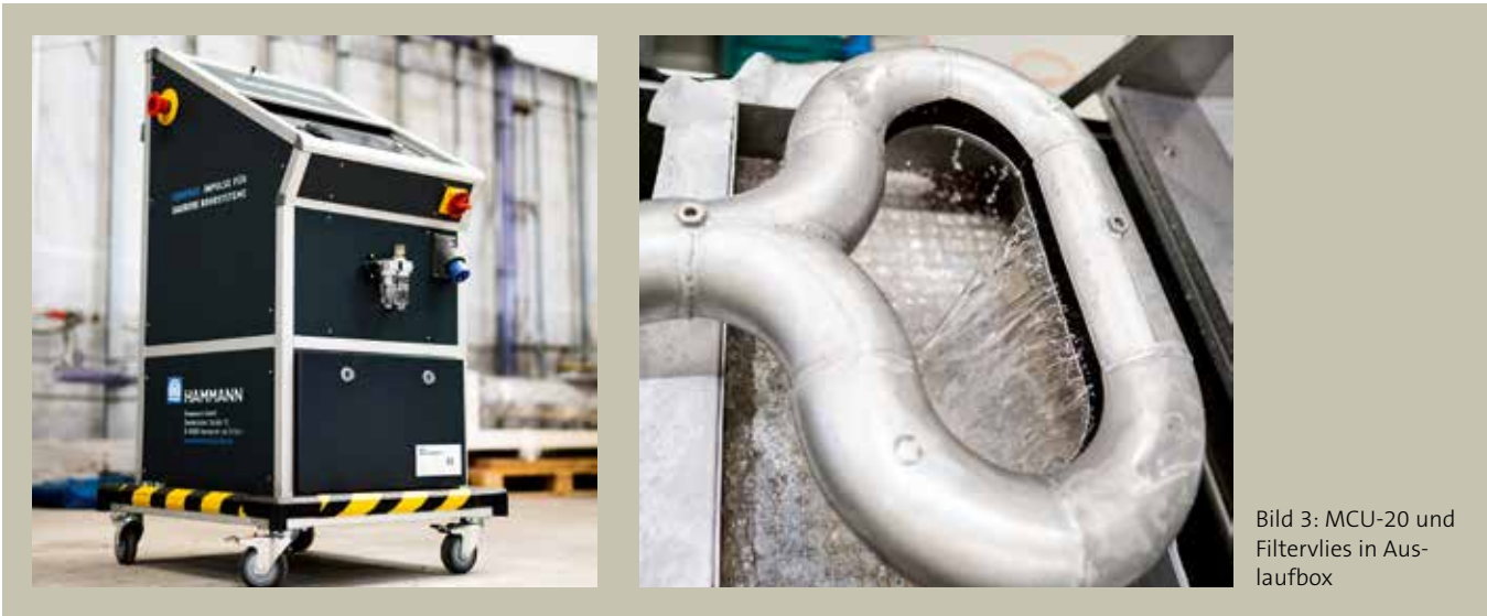
Bild 2: Austrag aus Werkzeug- und Maschinenkreisläufen der Spritzgießmaschinen im Filtervlies der Connect-Box
