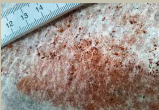
Bild 5: Ausgetragene Feststoffe aus Spritzgießwerkzeug auf Filtervlies
